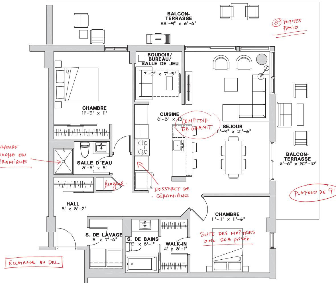
Notes : Logements 120, 320, 520, 720 : plafond béton apparent / Logements 220, 420, 620 : plafond de gypse / Plan à titre indicatif seulement / Luminaire de la salle de séjour inclus et installé.
